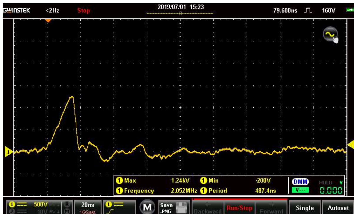
Obr. 2 Oscilogram zbytkového přepětí u(t) za ochranou SPKO-F75-SAT/TV-B / F-F při zkoušce rázovou vlnou 4 kA, 10/350 \mu s
